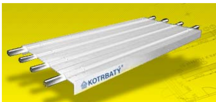
Obr. 15 Panelová jednotka složená ze 4 segmentů délky 3m. Šířka panelové jednotky je 4 \times 150\text{cm} = 60\text{cm} (obsahuje 4 otopné trubky).
