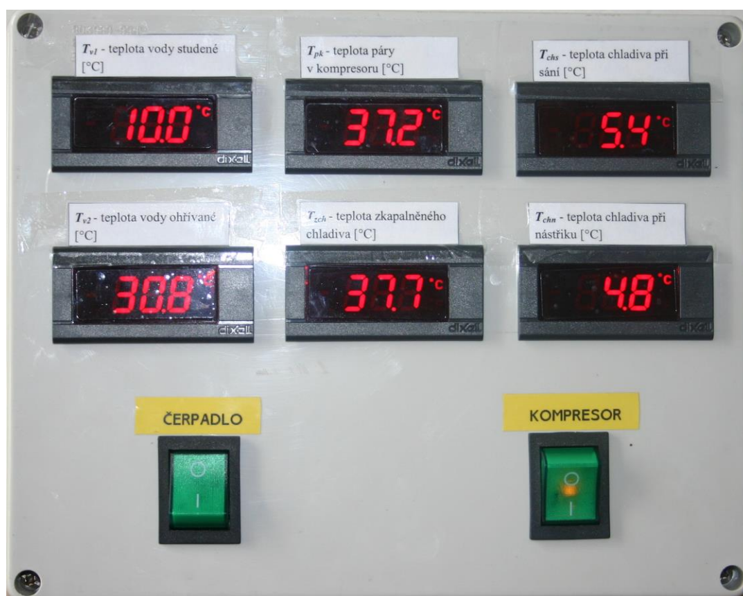
Obr. 5: Ovládací panel pro zapnutí kompresoru a čerpadla (pro rovnoměrné rozložení teploty v nádobě s vodou kondenzátoru). Zobrazené teploty přísluší různým částem tepelného čerpadla.
