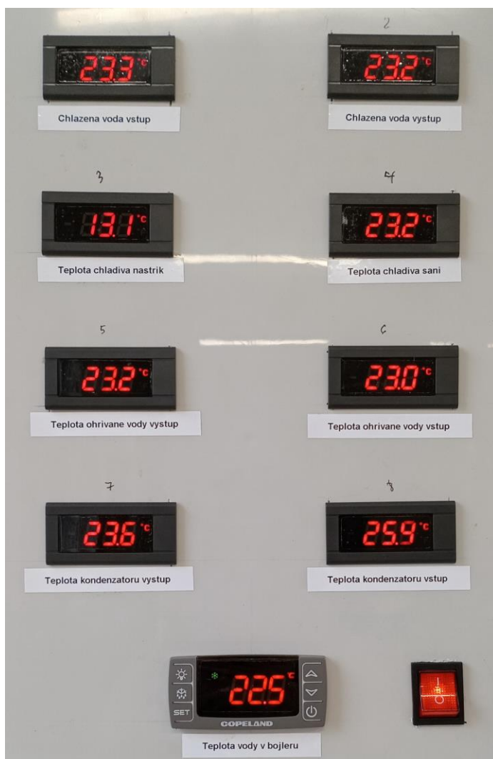
Obr. 5: Ovládací panel pro zapnutí kompresoru. Zobrazené teploty přísluší různým částem tepelného čerpadla.
