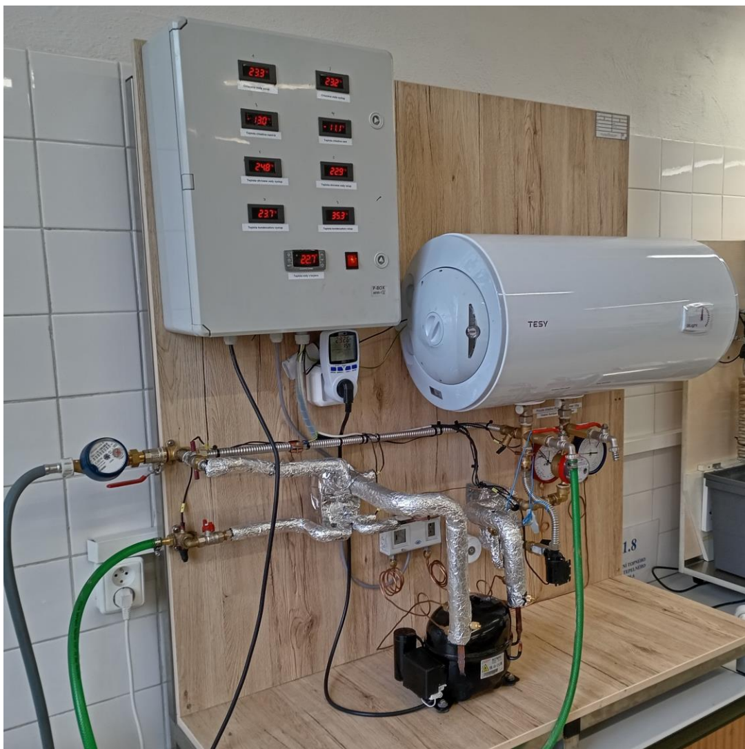
Obr. 1: Vyobrazení laboratorního tepelného čerpadla.
