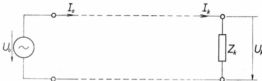
Obr. 8.26: Homogenní vedení zakončené obecnou impedancí
