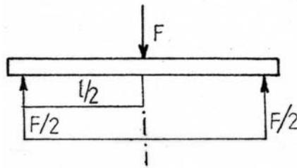
Obr. 1.5 Průhyb nosníku
