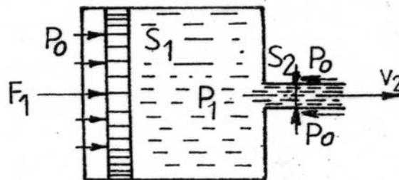
Obr. 4.8 Výtok kapaliny za přetlaku
