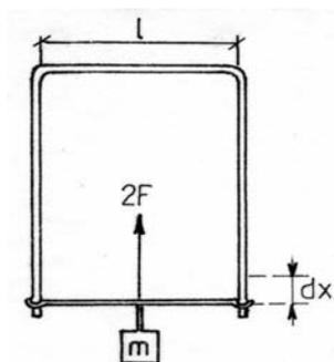
Obr. 2.2 Experimentální určení povrchového napětí
