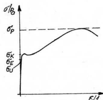
obr.1.1 Závislost napětí na relativním prodloužení
