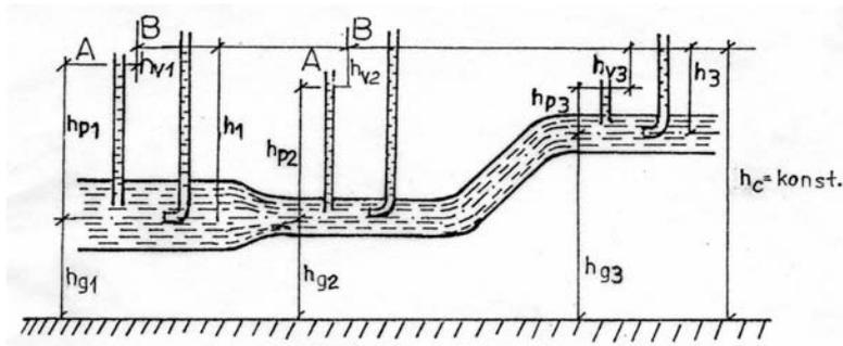
Obr. 4.7 Změny tlaku v potrubí podle Bernoulliovy rovnice
