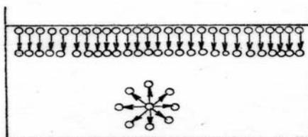
Obr. 2.1 Rozložení sil působících na molekuly v kapalině
