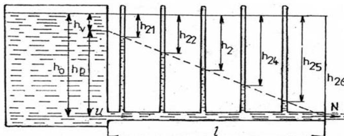
Obr. 4.15 Pokles tlaku způsobený vnitřním třením kapaliny
