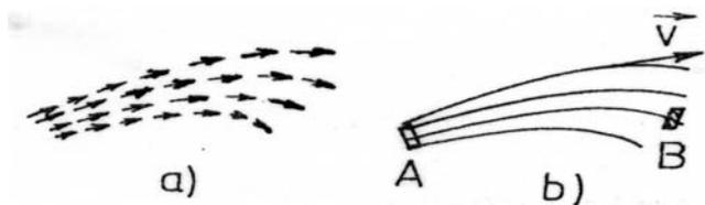
Obr. 4.1 Proudnice proudící kapaliny
